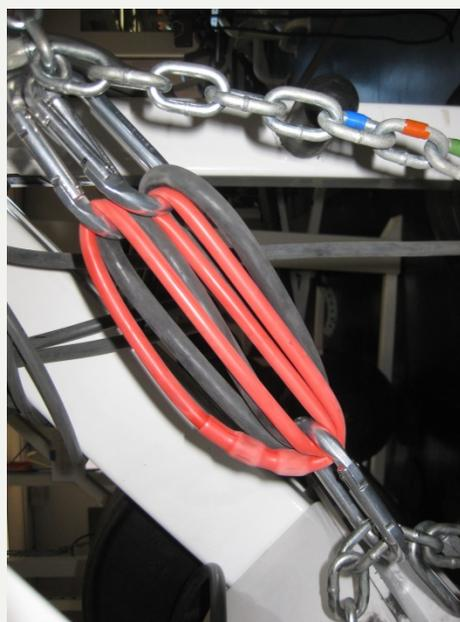
Alternativa da conexão utilizando 3 mosquetões.
